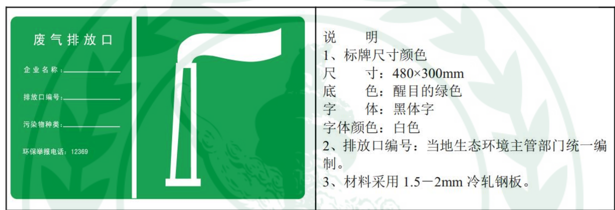
图2 废气排放口标志牌
